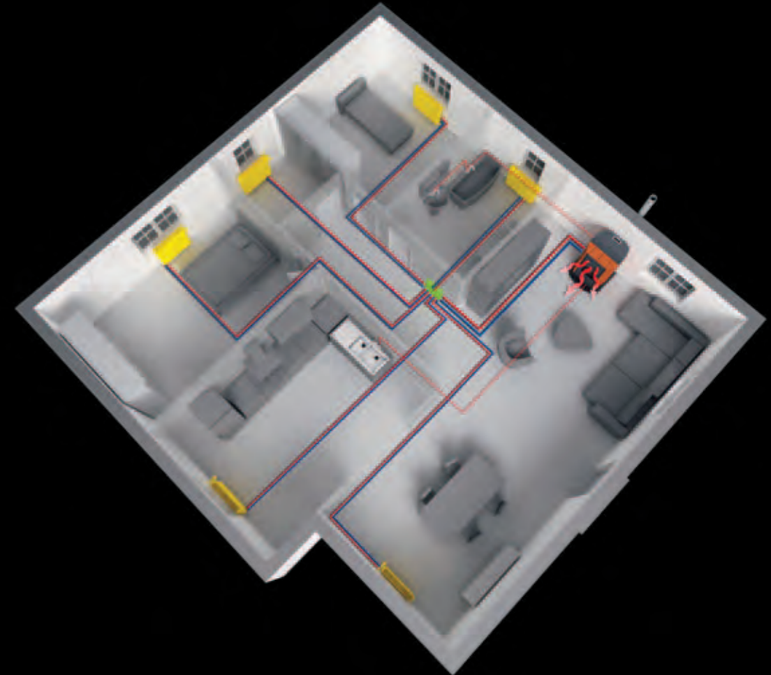
Esempio di inserimento/installazione di una termostufa in un appartamento tipo. Example of water heating stove installation in a apartment.
