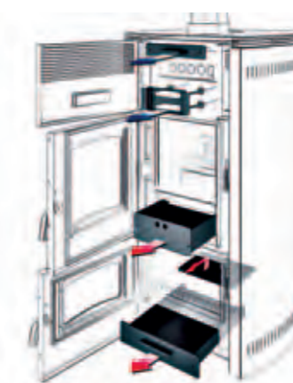
Particolare pulizia / Cleaning detail
