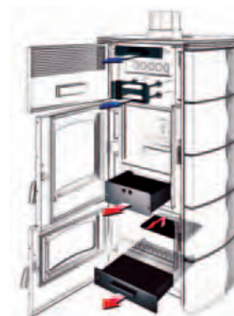
Particolare pulizia / Cleaning detail
