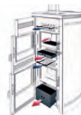
Particolare pulizia / Cleaning detail
